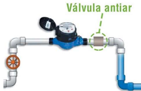
Vejam nesta ilustração que a válvula antiar é instalada na canalização do hidrômetro antes da água e o ar passar pelo relógio medidor de consumo
